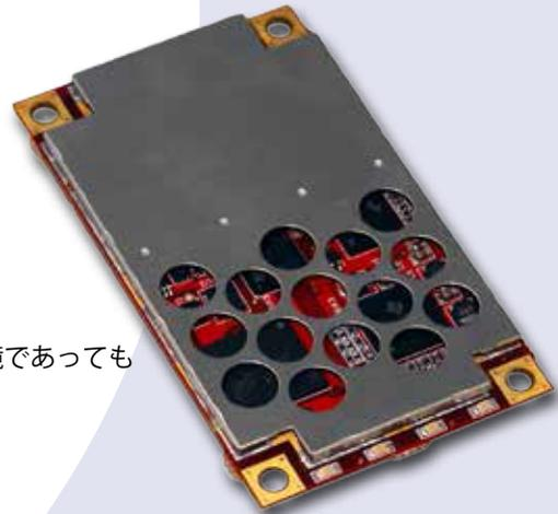
ヘミスフィアのCrescent™ P206™ 及び P207™ OEM モジュールはGPS、GLONASS、BeiDouを使用したMulti GNSS動作のみならず、Galileo、QZSSにも対応しています。無駄を省いた小型・軽量のコンパクトサイズながら、多くの信号を追跡することで過酷な環境下であっても高精度な測位が可能です。
