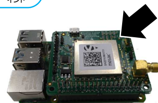
Raspberry Pi への取り付け例 (COCOLO-HeArT♥単独での利用も可能です)
